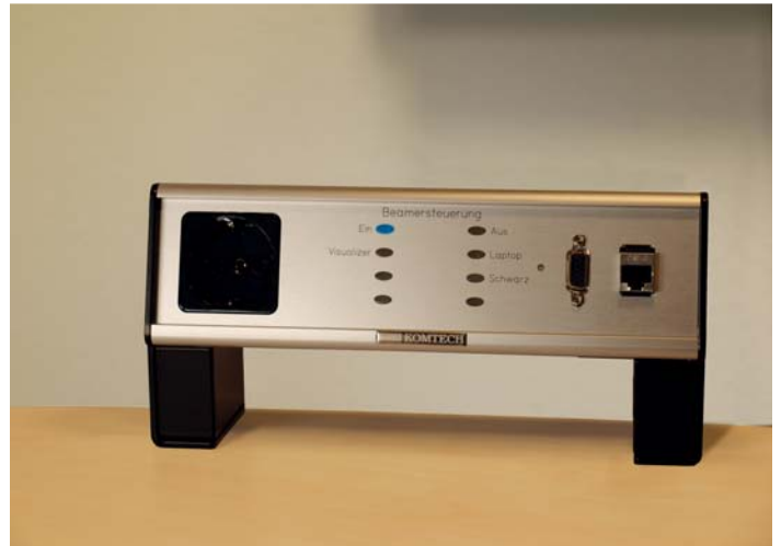
DP-230 mit Beispielbestückung (u. a. PI/OSsteuerung)
