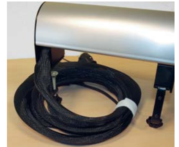
Alle Kabel ordentlich im Geflechschlauch zusammengefasst.
